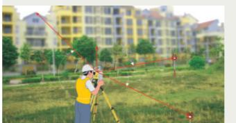
自由设站可计算出测站三维坐标及水平度盘零方向,可以使用多达5个已知点作为后视点参与计算,同时支持盘左盘右双面观测,极大地提高了准确性。
