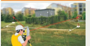
对边测量程序用来测定两点间的距离、坡度、方位角及高差。所测对边可以是连续的折线和源于一个中心点的射线。在测量过程中,最后两点可以即时进行对边检查。
