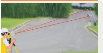
隐蔽点测量主要用于测量那些无法直立棱镜进行测量的点,测量前要先配置杆的长度和棱镜间距,隐蔽点测量杆可以任意角度放置在隐蔽点上,测量完成后程序可以计算出隐蔽点坐标。
