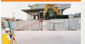
悬高测量主要用于测定建筑物的净空高以及电力线高度等,可以通过先测量放置于目标点正下方的基点再瞄准目标点的方法计算得到。
