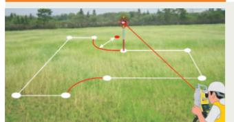
利用参考线进行点的放样和检核。根据已定义的参考线计算目标点的正交放样元素,参考线可以按需要进行平移及旋转。
