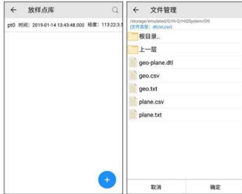
软件支持 dtl、txt、csv 三种格式的放样文件，模板已经内置在软件中，用户可以拷贝出来，参考模板制作放样文件。
