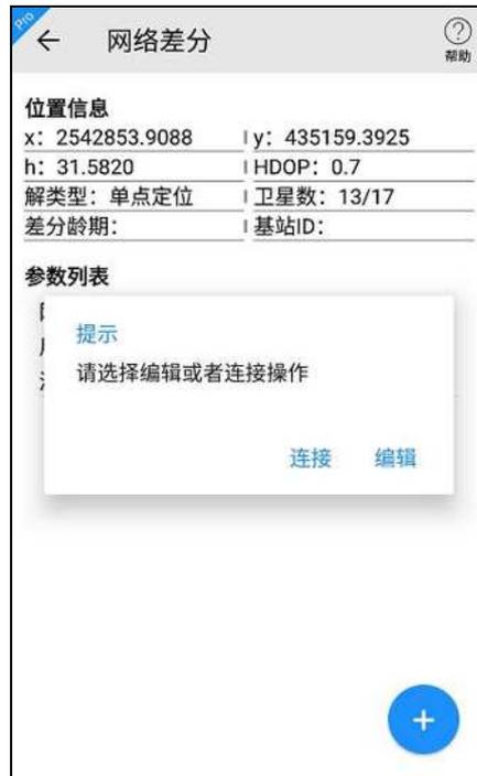
连接网络差分后，网络差分界面显示如下图。出现图标代表连接成功，同时显示数据实时传输速度；连接差分后，点击正在连接的某一行，可以断开连接的网络差分。
