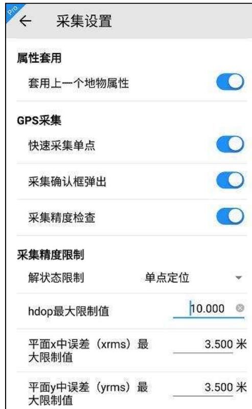
属性套用功能默认开启，开启后可将该图层采集的上一条数据的属性信息自动填入本次采集数据的属性中。
