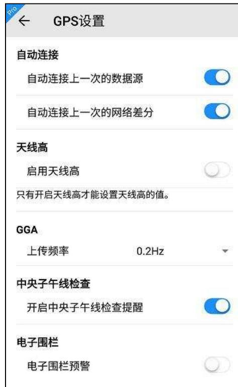
自动连接上一次的数据源和网络差分功能默认开启，进入软件后提示是否连接上一次的数据源和网络差分。效果如下图所示：
