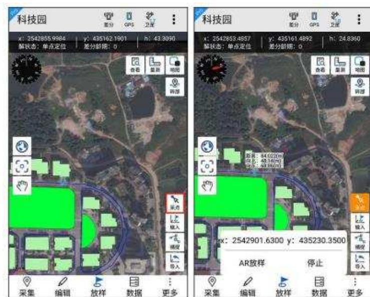
当前 GPS 点处会实时显示两点间距离, 并随着当前 GPS 位置走动而计算距离并更新显示, 到达目标点, 提示用户到达目标点, 并自动结束放样。
