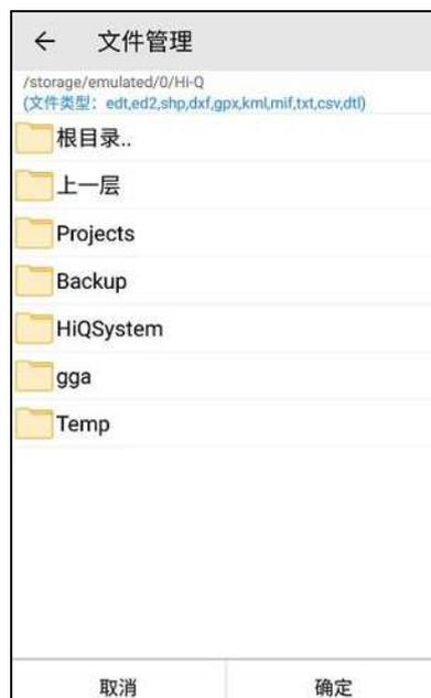
【注意：Hi-Q 软件中仅支持 edt、ed2、shp、txt、csv、dtl 格式，Hi-Q Pro 软件中支持全部格式。导入图层所选取的导入文件需要与当前坐标系统一致，若不一致，导入后的坐标可能显示异常】
