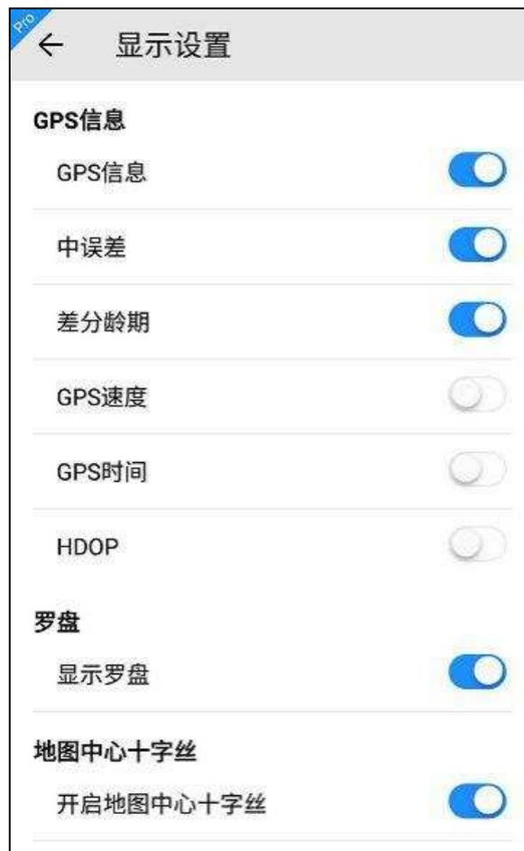
GPS 信息显示默认开启，在采集主界面上方可查看 GPS 信息，关闭后下方的中误差显示、差分龄期、GPS 速度、GPS 时间和 HDOP 则不显示，采集主界面上方不显示 GPS 信息。中误差显示、差分龄期默认开启，开启后可在采集主界面上方 GPS 信息中查看中误差、差分龄期信息。GPS 速度、GPS 时间、HDOP 默认关闭，开启后可在采集主界面上方 GPS 信息中查看 GPS 速度、GPS 时间、HDOP 信息。
