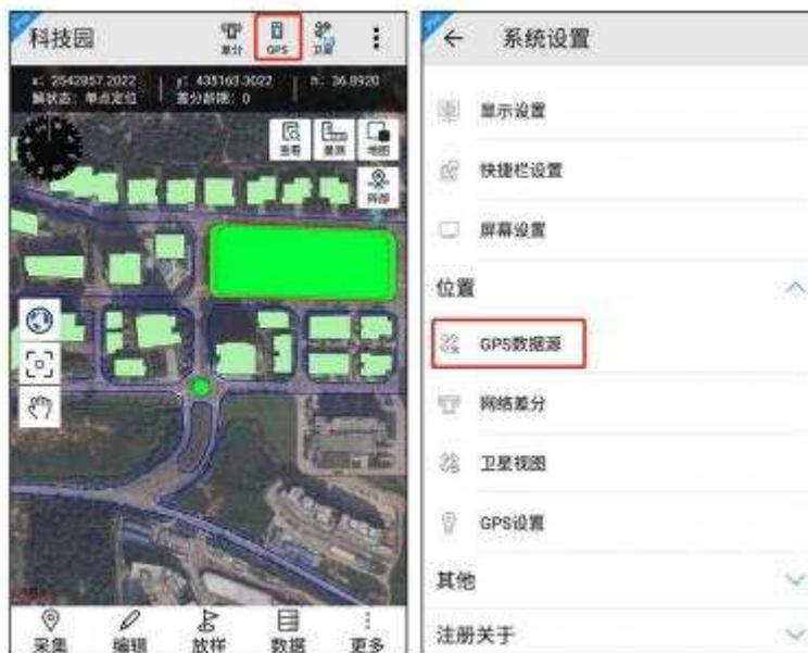
GPS 界面分为两部分：配置信息和设备配对。配置信息显示工作模式、设备信息、过期时间。设备连接系统数据源时，工作模式中显示内置 GPS，设备连接蓝牙数据源，工作模式中显示移动站模式、静态模式或基准站模式；设备信息中显示系统或连接的蓝牙数据源的设备名称及系统版本；过期时间中显示系统或连接的蓝牙数据源的过期时间，若已过期，显示为红色，连接蓝牙数据源后可对蓝牙数据源进行注册。
