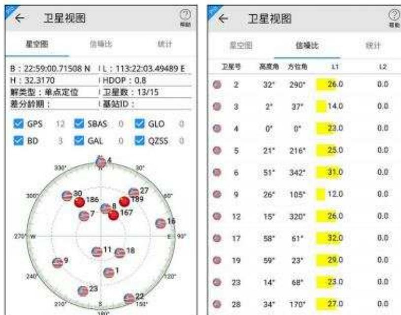
在统计界面，可对卫星的信噪比信息进行统计，统计的信息可进行导出。
