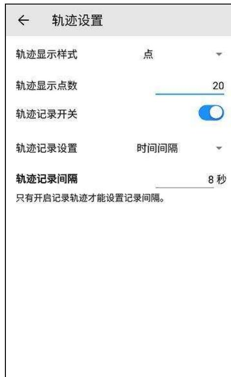
在【轨迹显示样式】中可设置轨迹在采集主界面显示为点或者线；在【轨迹显示点数】中可设置轨迹在采集主界面显示的点数，设置范围为[0,100]；在【轨迹记录开关】中可设置轨迹记录开关，轨迹开启后，可设置轨迹记录方式（支持根据时间间隔和距离间隔记录）和轨迹记录间隔。
