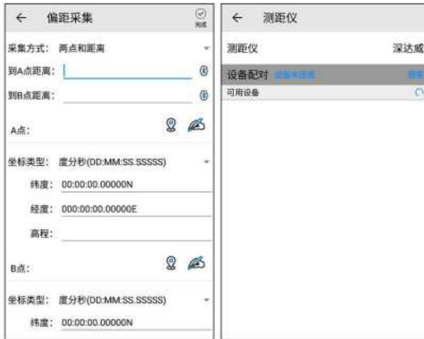
采集方式支持两点 and 距离、两点 and 夹角、单点距离 and 方位角、首尾点 and 等距点。
