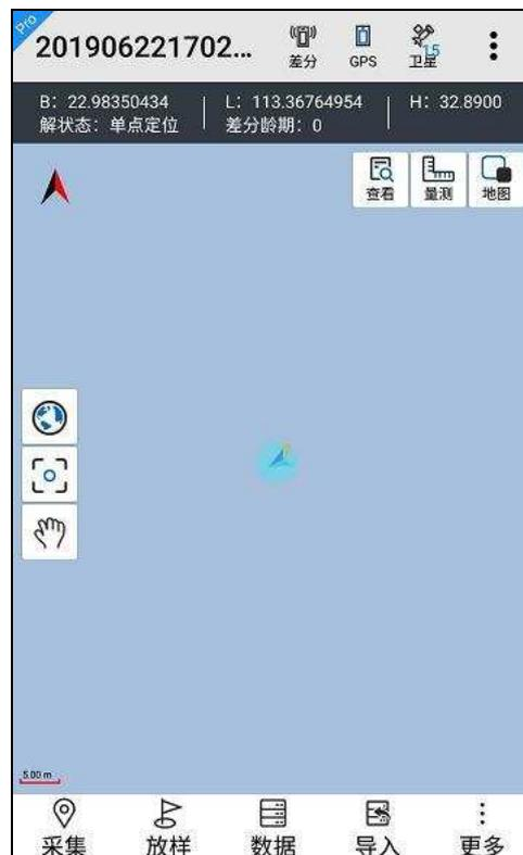
地图中心十字丝默认关闭, 开启后地图界面会始终显示十字丝, 可以进行中心点采集, 如下图所示:
