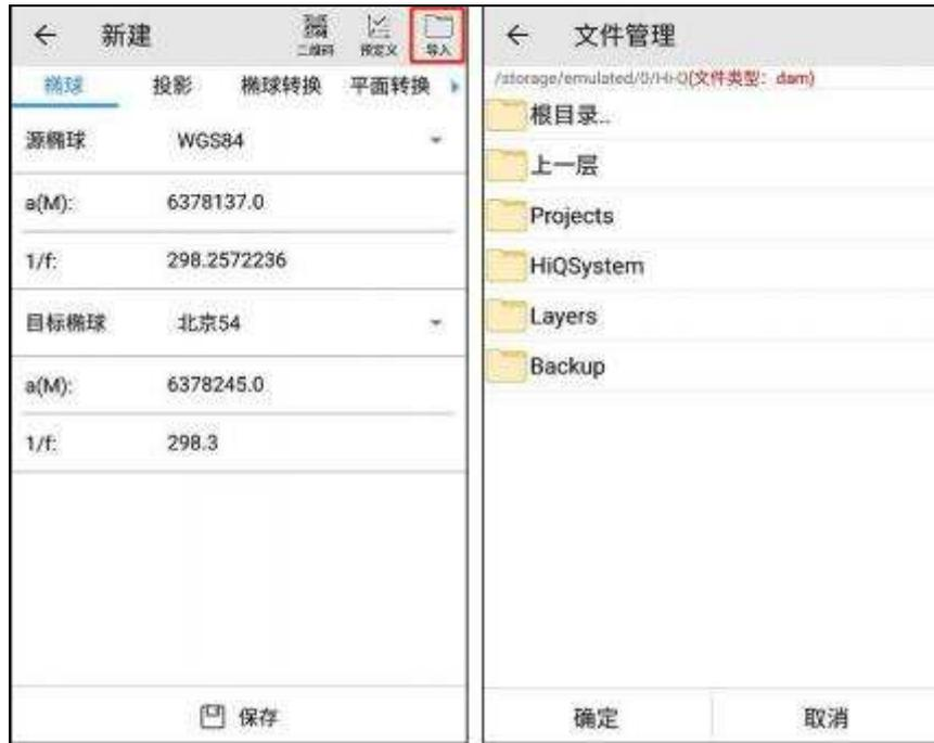
4. 点击新建界面的二维码按钮，可通过二维码扫描进行识别坐标系，操作步骤如下：
