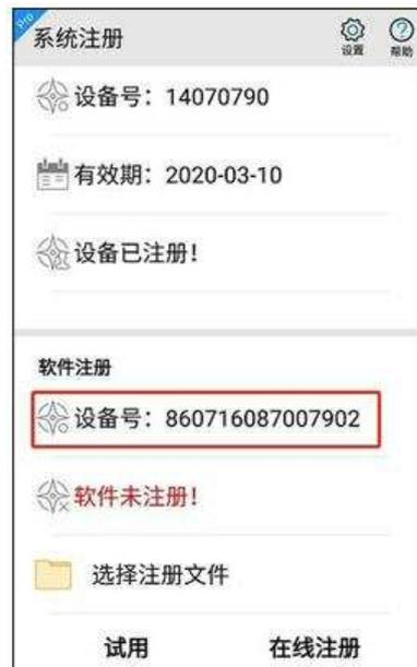
设备注册可进行在线注册地址设置，点击【设置】，可进行注册码网络路径设置，设置后，若服务器中存在此设备的设备注册码，即可连接服务器获取设备注册码。
