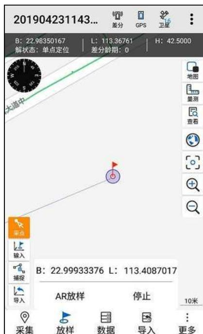
**【注意：放样精度必须高于放样提示精度】**
