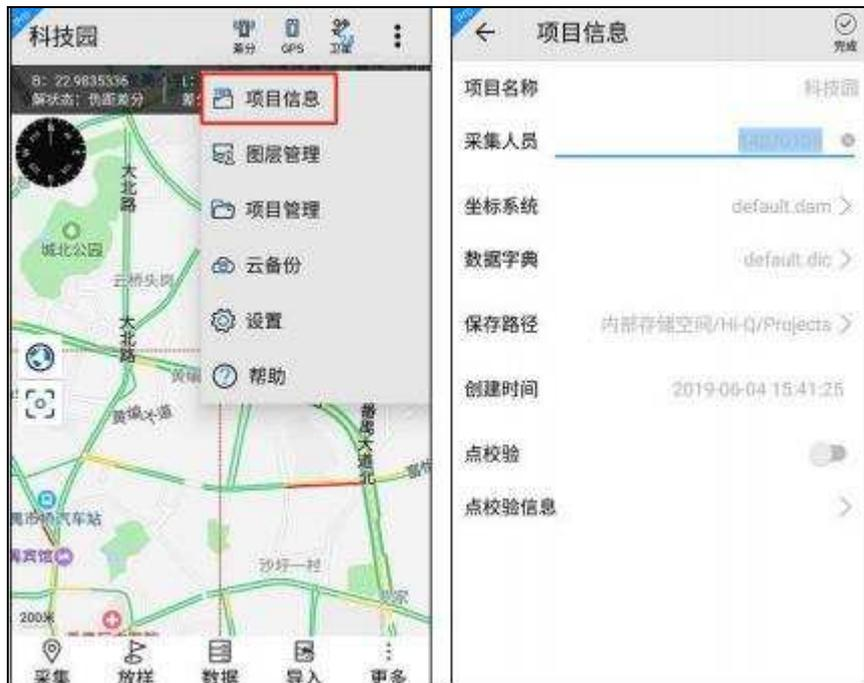
项目信息界面可查看项目名称、采集人员、坐标系统、数据字典、保存路径、创建时间、点校验、点校验信息，其中采集人员、坐标系统、点校验、点校验信息可修改。
