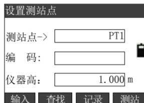
6) 屏幕返回设置测站点界面。用[▼]键将→移动到编码栏;
