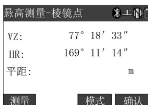
对准棱镜，按[测量]键，测得棱镜到仪器的平距；对所测平距进行确
