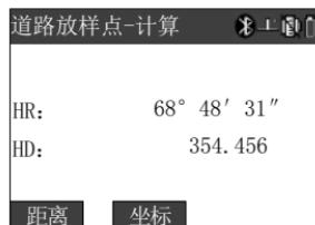
可以选择 F1[距离]——进行极坐标放样；选择 F2[坐标]——进行坐标放样；参见坐标放样和极坐标放样中的描述。以上每个窗口的[ESC]键都返回到列示桩点里程的窗口，供选择待放样的桩点。
