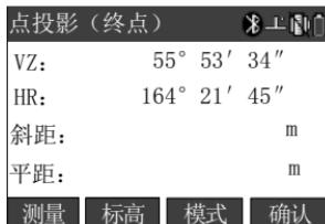
按[测量]键启动测距。完成测距后，按[确认]键结束基线定义返回点投影测量主界面，选择“3.点投影测量”可以进行点投影的测量了。
