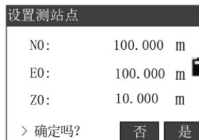
5) 系统查找当前坐标文件, 找到点名, 则将该点的坐标数据显示在屏幕上, 按[F4] (是) 确认测站点坐标, 并返回到测站点设置主界面;
