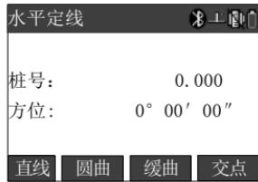
如果首次选择的是“交点”输入法，则以后的输入就是交点输入法。选择一个元素法的线型，若还没有输入起点，则进入“水平定线-起始点”的输入，之后再选择其他线型输入，结束后按[ENT]键，则进入线路列表界面。
