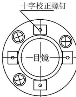
**注意：**校正后应检查光电同轴性。
