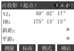
按 [测量]键启动测距，完成测距后，按[确认]键进入“点投影（终点）”窗口；
