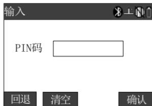
输入 PIN 码 (82543) 之后按[确认]键，仪器关机；
