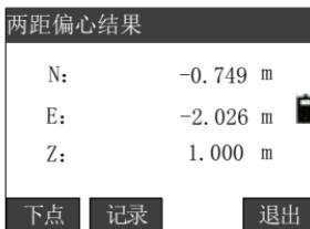
如果待测点是 A0 点则目标高为 0，如果希望测量 A1 点则必须根据实际情况输入正确的目标高。按[下点]键时进入下一平面的偏心测量；按[记录]键记录偏心点坐标；按[ESC]键退出两距偏心测量。
