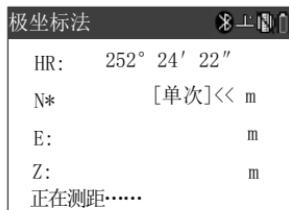
4)测量结束，显示测得的坐标值，按[F4]（是）键记录。点名与坐标值存入坐标数据文件显示下一个新点输入菜单，点号自动加 1。
