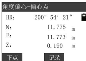
此时，转动望远镜瞄准偏心点，即可得到偏心点的坐标。按[下点]键进入下一点的偏心测量；按[记录]键记录偏心点坐标；按[ESC]键退出角度偏心测量。
