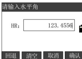
●输入完成后，按[F4]确认输入，按[ESC]键取消，角度大于360度时提示“角度超出！”。
