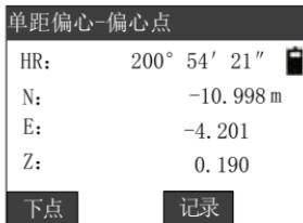
显示偏心点的坐标。按[下点]键时进入下一点的偏心测量；按[记录]键记录偏心点坐标；并且按[ESC]键退出单距偏心测量。
