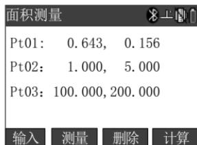
面积测量的最大点数是 20 点。（由于界面有限，列表中坐标会显示不全）**测量和输入的坐标总是插入在列表框中当前选择条的下一条，这一点对需要在中间插入坐标时很重要。**面积计算时总是从起点到终点逐点连接起来成为一个多边形，然后计算多边形的面积，因此对中间有交叉的图形是无法得到正确的面积的。**可以按[★]键查看多边形的形状。**当输入数量达到 3 点(包括 3 点)以上时可以计算面积。此时也会出现[计算]键，表示满足计算条件。按[计算]键，即可显示面积和周长的结果。按[ESC]按键退出面积测量。
