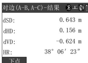
此时显示的是起点是第一点到第二点的测量结果；按[下点]键继续对边测量——重复“第二步”和“结果”窗口，即可得到第一点与其他点的测量结果。
