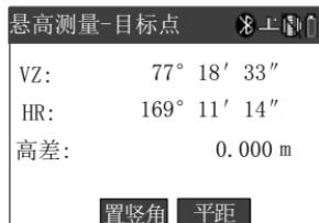
此后俯仰转动望远镜，在“高差”处所显示即为目标点到参考点的高差。
