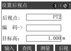
6) 屏幕返回设置后视点界面。按同样方法，输入点编码、目标高；
