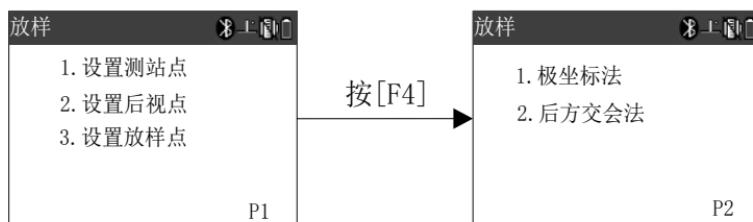
其中：设置测站点和设置后视点是放样的准备工作，如果确认在其它的功能中已经进行了设置站点和后视点的操作，这些操作也可以不做，设置测站点的操作方法参见数据采集中的测站，设置后视点的操作方法参见数据采集中的后视。设置后视点和方位角的目的是一样的，就
