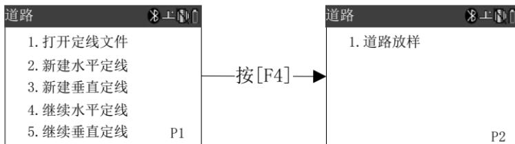
如果通过导入的方式已将定线文件存入了仪器，则可以通过“打开定线文件”方式将定线文件打开，打开定线文件时要求水平定线和垂直定线文件一起打开。打开定线文件后，可以选择的操作是：“道路放样”“继续水平定线”“继续垂直定线”。
