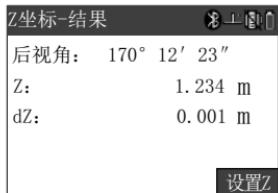
此后可以通过“设置 Z”来设置测站 Z 坐标，如果需要可用“置角”键设置仪器后视角度，按[ESC]退出 Z 坐标测量。
