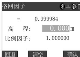
高度编辑框中输入高度后，按[确认]键即计算出如图例所示的格网因子。按[ENT]键保存格网因子并退出，例外的情况是：当算出的格网因子小于 0.99 或者大于 1.01 时说明高度或者比例中的一项输入有误，此时的格网因子是系统不能接受的，因此必须重新输入。按[ESC]键退出则不保存。
