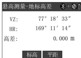
此后，俯仰转动望远镜，瞄准目标点，“高差”处所显示的即为目标点到地面的高差；
