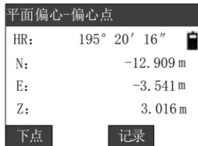
转动仪器照准偏心点——请注意此时偏心点一定是平面上的点而不是棱镜杆下的点，否则结果不正确。照准后即可得到偏心点的坐标。在瞄准过程中，坐标值一直在刷新。按[下点]键时进入下一平面的偏心测量；按[记录]键记录偏心点坐标；按[ESC]键退出平面偏心测量。
