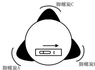
②将仪器绕竖轴旋转  $90^{\circ}$  ,再旋转另一个脚螺旋 C,使管水准器气泡居中。
