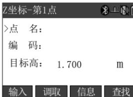
按[输入]键，输入第一点的点名，坐标，以及目标高，其输入方式与“后视”坐标输入方式相同。按[确认]或[ENT]键结束输入，再按一次[ENT]键进入“Z 坐标-第 1 点”测量窗口；
