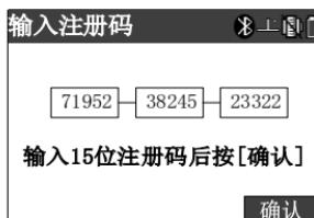
3)输入正确注册码后，按[确认]键，提示已注册，可进行存储点
