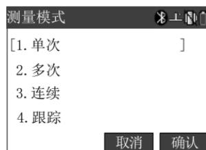
按[▲][▼]键移动“[]”指针到所要求的选项，按[确认]键接受选择，并将设置保存到系统文件。仪器以后开机后的默认测距模式既是所选择的模式。其他所有设置的操作和用途都与测距模式设置相似，这里不再
