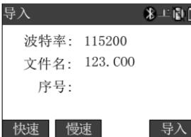
在进行文件导入时可进行的设置是“波特率”，文件的导入采用 RS232C 串行通讯总线从外部设备中获取数据，波特率可以选择 2400、4800、9600、19200、38400、57600、115200，这些设置通过[快速]、[慢速]键进行选择，通常如果没有什么特殊的原因，采用 115200（最高）的波特率是可以可靠地完成数据传输的。
