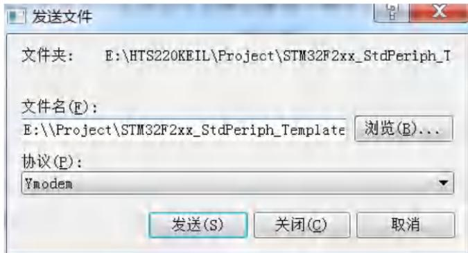
5)之后显示发送程序的进程，在结束后，可以按[5]键，更新仪器的开机图片，方法同升级应用程序相同；也可以按[6]键更新词条文件；
