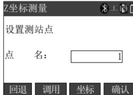
这里，可以按[坐标]键，直接输入站点坐标，也可按[调用]键，在已知文件中调用坐标。
