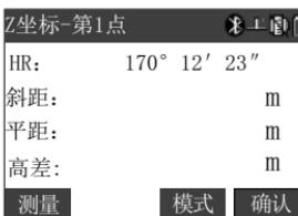
第三步：按[测量]键启动测量，测量完成后，显示“斜距”、“平距”、“高差”，按[确认]键，表示认可本次测量有效，此时出现[继续][模式][计算]键，如果按[继续]则进行“Z 坐标-第 2 点”的输入和测量，如果按[计算]则进入“Z 坐标-结果”窗口；
