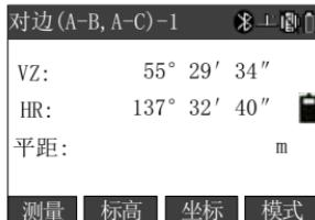
2) 按[标高]键，输入仪器高和目标高，按[测量]键测出起点坐标或按[CORD]键输入点坐标，按[ENT]确认，进入“对边(A-B,A-C)-2”窗口；
