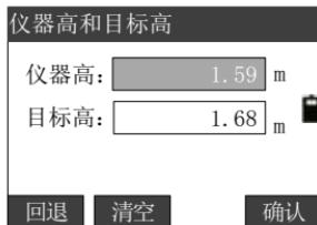
仪器对仪器高和目标高的输入是有要求的，当超出±999.999，按[ENT]键后系统提示“仪器高超出”和“目标高超出”。
