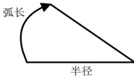
半径和长度见示意图的说明。半径的输入允许为负，规定沿道路的前进方向上右拐为“+”，左拐为“-”，半径为曲线终点半径。长度即弧长。
