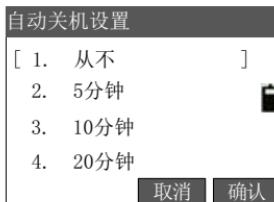
可以选择“从不”——取消自动关机功能，也可以选择当5分钟、10分钟或20分钟没有按键操作时自动关机，达到省电的目的。操作时按[▲][▼]键移动选择指示符“[]”到对应的选项，按[确认]或[ENT]键，系统提示“已保存”，[ESC]则保持原来的设置。
