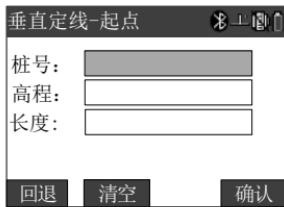
输入好起点桩号、高程和长度后，按[确认]，进行第 01 点的输入，如图：
