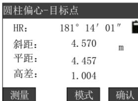
如果要测量的是 P0 点的坐标, 请在测量前输入标高 0, 如需测定 P0' 点的坐标, 则按实际的标高进行输入, 然后按[测量]键启动测量, 完成测量后出现[确认]按键, 按[确认]键接受测量数据, 并进入“圆柱偏心-左边缘”窗口:
