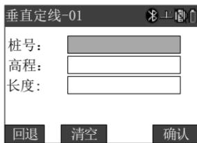
然后依次输入后续点的桩号、高程和长度，最后按[ESC]键结束输入，并进入“竖曲线列表”，[保存]、[查看]、[编辑]等的操作参见水平定线的元素法。
