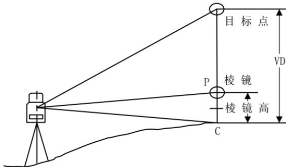
有两种方式可以进行悬高测量，当需要目标点到地面点的高度时选择“输入棱镜高”模式，当需要目标点到任一参考点的高度时选择“无需目标高”模式。
