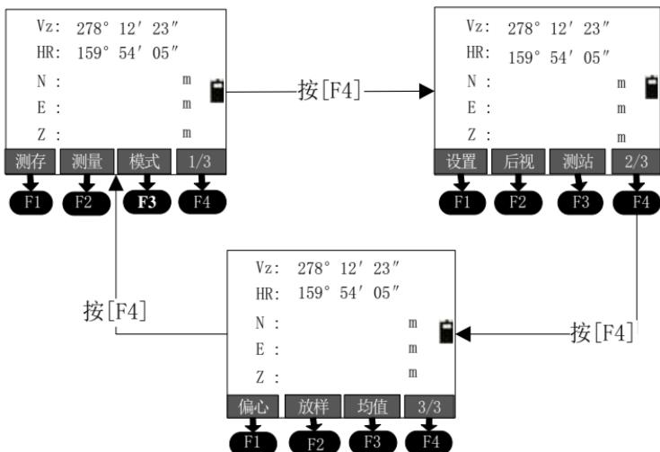
**(1) 测存:** 按[F1]键后，测点完成后出现是否记录，点击“是”后出现输入“测点信息”窗口，(如果事先没有选择过测量文件的话，此时出现“选择文件”对话框进行文件选择)，要求输入所测点的点名、编码、目标高。其中点名的顺序是在上一个点名序号上自动加1。编码则根据的需要输入，而目标高则根据实际情况入。按[ENT]键则保存坐标数据到测量和坐标文件。
