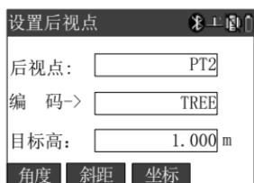
8) 照准后视点，选择一种测量模式并按相应的按键。例如：[F2] (斜距)，直接对后视点进行测量；
