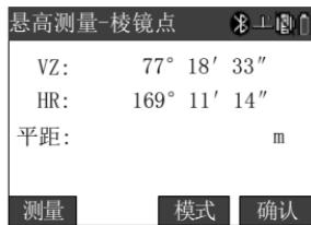
瞄准棱镜，按[测量]键，测出目标到仪器的平距；按[确认]键进入“悬高测量—地标高差”窗口；
