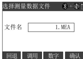
选择好测量数据文件后, 按[确认]或[ENT]键, 进入导出格式选择窗口。“本机格式”指使用配套的传输软件可以正常接收并解析的格式; “SSS 格式”指拓普康 (GTS-7) 的格式, 不能使用光盘中的传输软件接收数据, 需要使用 Topcon link 或其他能识别 SSS 格式的软件。
