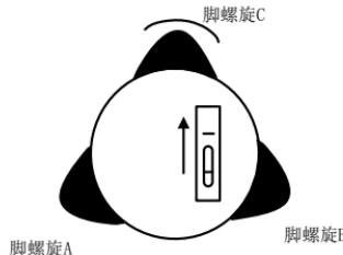
③再次旋转仪器  $90^{\circ}$  ,重复步骤①、②,直到四个位置上气泡居中为止。
