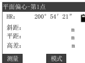
按[测量]键测量第一点，测量完成后出现[确认]按键，按[确认]键接受测量数据。注意，在进入测量前标高数据自动设置成 0。按[确认]键后并进入“平面偏心-第 2 点”窗口，使用与第一点测量相同的操作，获取第二、第三点的数据后进入“平面偏心-偏心点”窗口：
