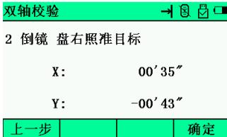
3 确认校正改正值是否在校正范围内, 如果 X 值和 Y 值均在校正范围内, 按 F4[确定]键对改正值进行更新, 反之退出校正操作, 并与仪器销售商进行联系。
